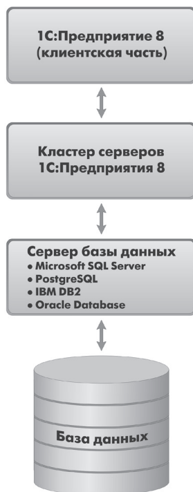
Рис. 5.47. Трехуровневая архитектура «1С:Предприятия»
